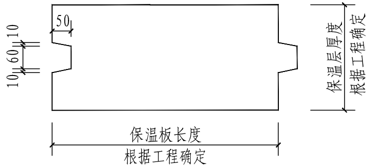
① 标准板断面图一（企口连接）
